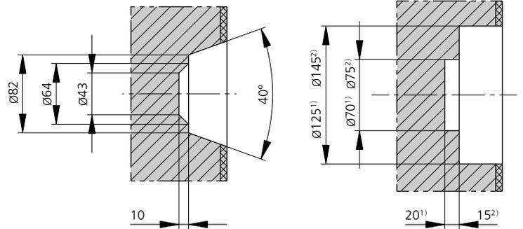
Unidad de inyección 800<sup>1)</sup> y 1300<sup>2)</sup> en ejecución para termostables - Unidad de inyección 2100 a petición
