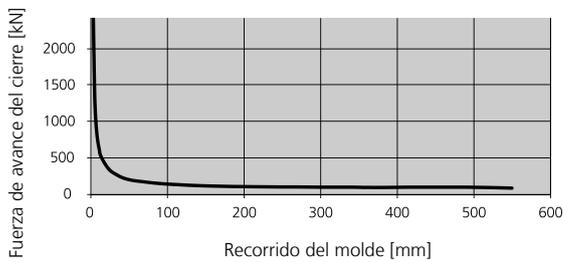
\* ajuste automático de la fuerza de cierre hasta 20 kN
