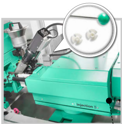
Microinyección: pesos por inyec- ción mínimos con unidad para microinyección del tamaño 5.
